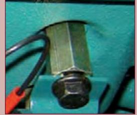
Foto 6.6 e 6.7 Per installare il relè è necessario allungare alcune viti.
