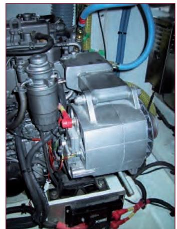
non offrono questa caratteristica. La verifica dell'isolamento è semplice: i due morsetti dove si collegano il cavo positivo e negativo di potenza sono dotati di rondelle o guarnizioni di plastica che isolano i prigionieri dalla carcassa (negativo non a massa).
