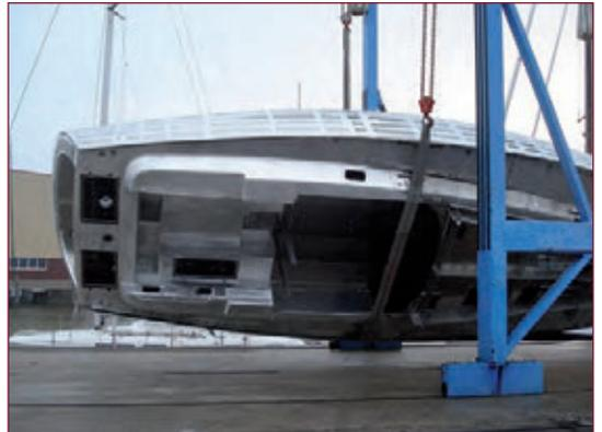
Foto 4.13 e 4.14 La rotazione dello scafo è una fase che richiede attenzione, si può fare con travel lift o con argani, appoggiando lo scafo a terra o meno, oppure con due gru.
