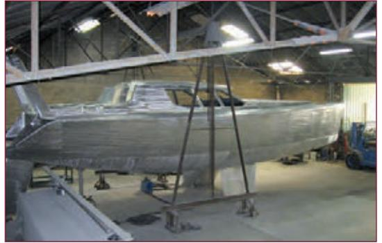
Foto 4.11 e 4.12 Struttura di un JFA 45 progetto Berret Racopeau bichiglia realizzato da Voisin.
