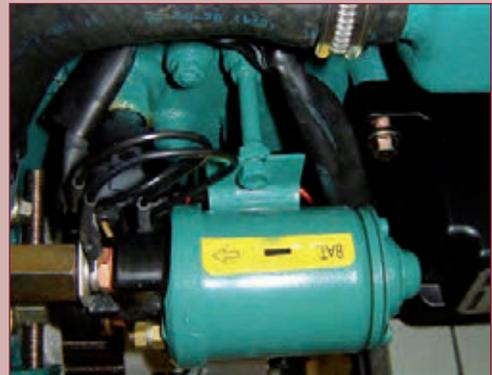
Foto 6.4 Inserimento del relè della massa o del negativo che viene imbullonato sul tubo di scappamento (*raiser*).
