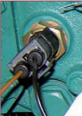
Foto 6.3 Sostituzione delle sonde di temperatura monopolari e montaggio di quella bipolare. Il cavo negativo da 1,5mm<sup>2</sup> viene collegato al relè.
