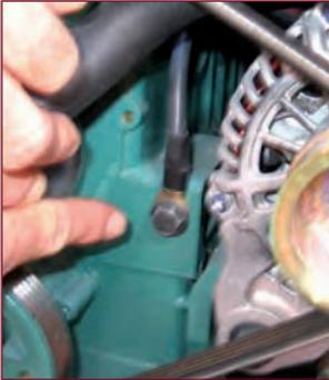
Foto 6.9 Viene eliminata la massa esistente sul motore che va quindi messa al relè.
