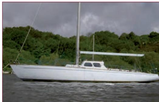
Foto 1.1 *Gulvain*, disegno Giles, una delle prime barche in alluminio rivettato, costruita nel 1949. Gilles-Mthivet
