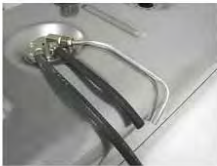
tubo di aspirazione (pescaggio) tubo di ritorno (drenaggio)
